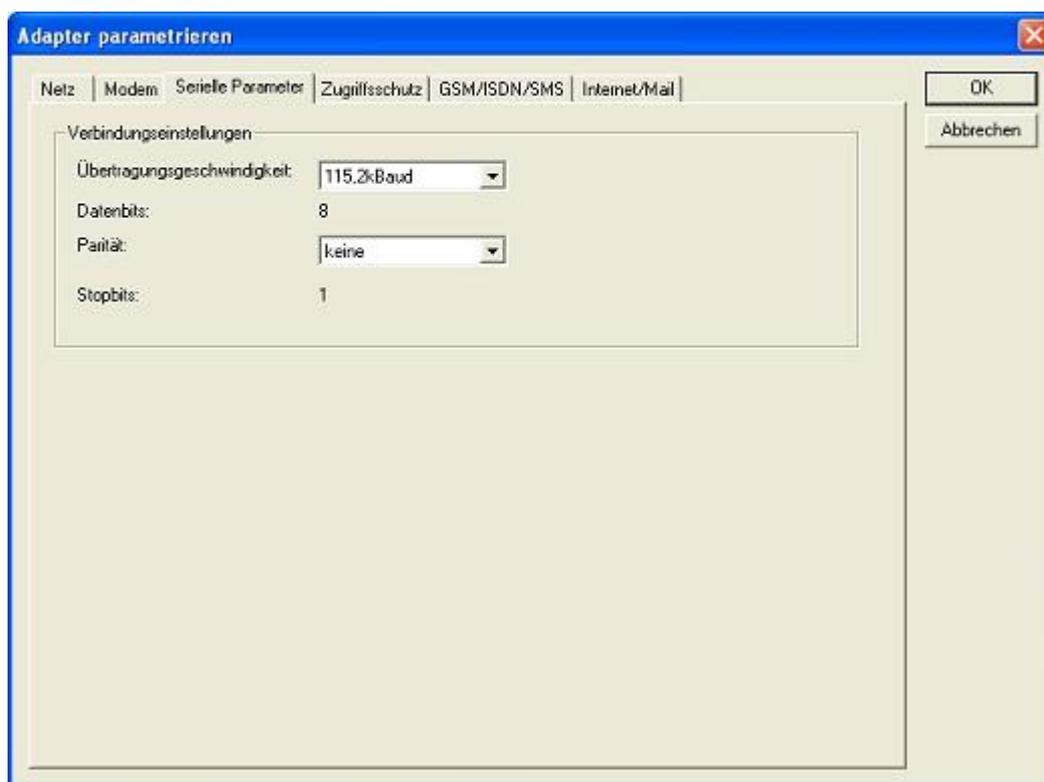
Hier werden die Übertragungsparameter zwischen Modem und dem TS-Adapter eingestellt.
