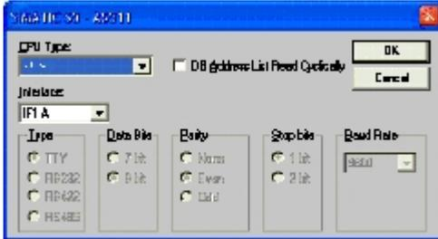
5. Über „Parameter...“ rufen Sie einen Einstellungsdialog für die ausgewählte SPS aus. Geben Sie in diesem die Teilnehmeradresse des Bedienterminals (im Beispiel „1“) und der Steuerung (Beispiel: „2“) an. Den Punkt Schnittstelle belassen Sie auf der Standard - Einstellung. Im Abschnitt „Netzparameter“ wählen Sie die Schnittstelle aus mit der Ihr Modul verbunden ist (Beispiel: „MPI“). Die Baudrate stellen Sie bitte auf „187.5“. |
