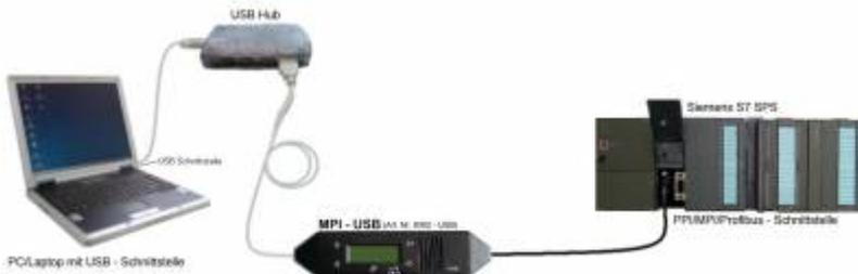
**MPI-USB Anschlussmöglichkeiten mit Bedienterminal**
