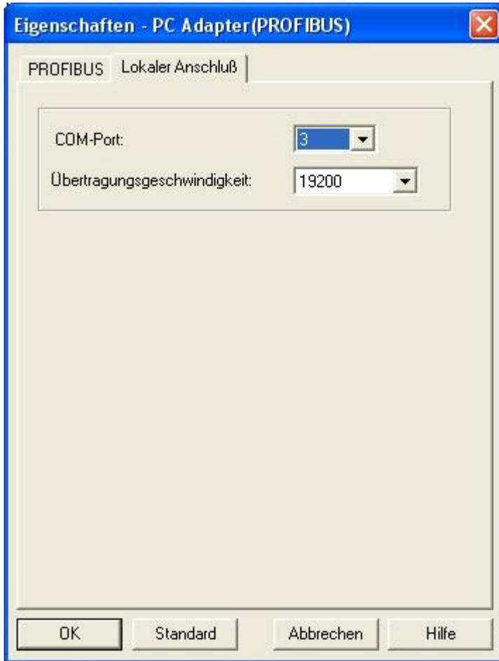
18. In der Register Karte „Lokaler Anschluß“ stellen Sie den COM Port ein. 19. Setzen Sie die „Übertragungsgeschwindigkeit:“ auf „19200“.
