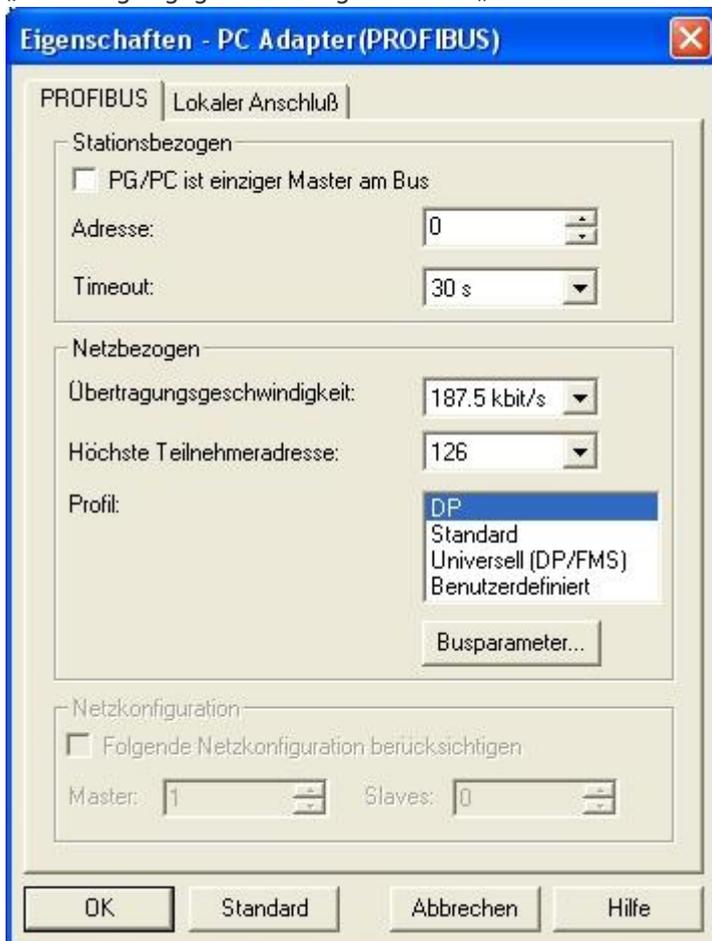
20. Wählen Sie die Register Karte „PROFIBUS“ an und setzen Sie die „Übertragungsgeschwindigkeit:“ auf „187,5kbit/s“.
