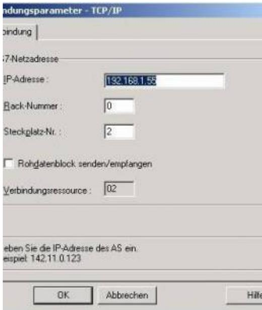
10. Es öffnet sich ein Dialog der Ihnen ermöglicht die Verbindungsparameter zu konfigurieren. Geben Sie die IP - Adresse des Moduls ein und vergeben Sie entsprechend Ihrem Aufbau die Rack- sowie die Steckplatznummer. Bestätigen Sie die Eingabe mit „OK“. Beispielkonfiguration:
