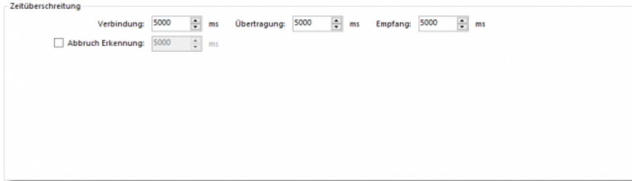
Die im Bereich **Zeitüberschreitung** definierten Werte werden für den Verbindungsaufbau zur SPS und während der Kommunikation verwendet.
